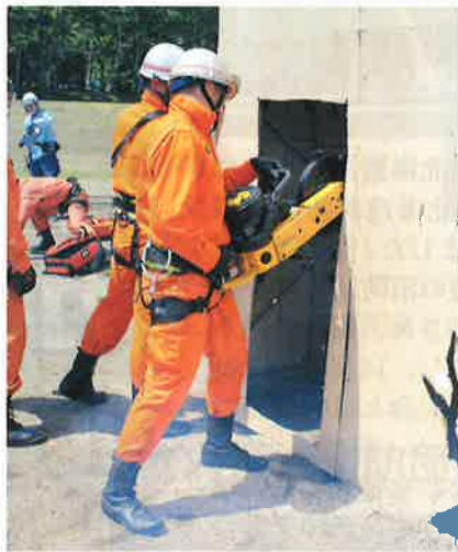
エンジンカッターによる進入路の確保
